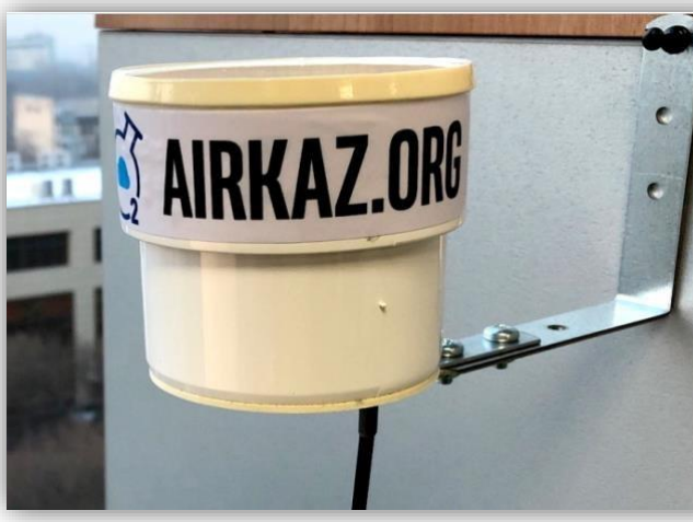
Рисунок 3. Фотография установленного датчика AirKaz (слева) и сертификат, выданный Кыргызстандартом (справа)
